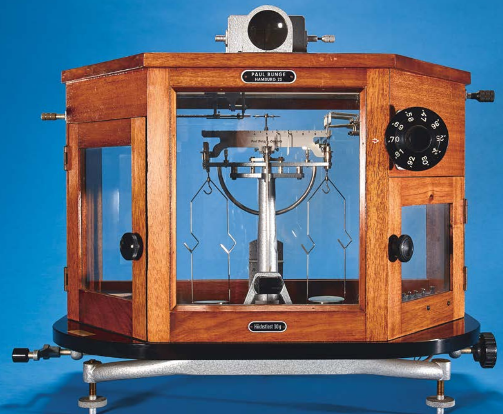
Feinwaage mit Gewichtsbestimmungen im Mikrogrammbereich
